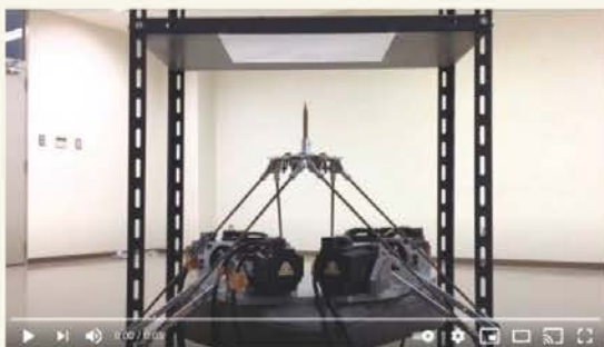
【動画】6自由度パラレルロボット HEXA の位置・接触力制御 - YouTube
