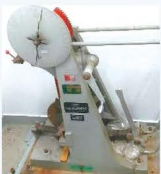
吸収エネルギー（破壊するために要したエネルギー）と試験片の韌性を測定します。接合部の力学特性を評価します。容量 98J
