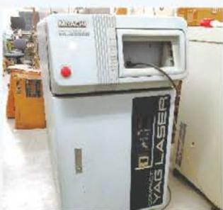
レーザ接合、切断に使用します。50WパルスYAGレーザ発振器を所有しています。
