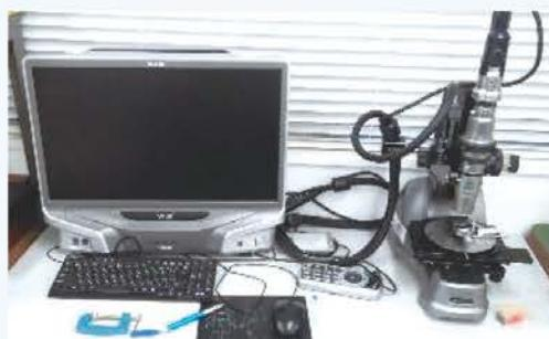
光学顕微鏡と同等の観察倍率でデジタル画像を撮影できます。寸法測定、2D および 3D 形状測定が可能です。
