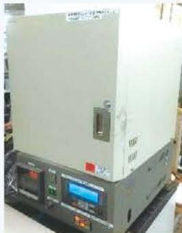
大気加熱炉、真空炉を所有しており、条件を変えての溶接実験を行うことができます。
