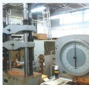
引張・圧縮試験および曲げ試験が可能です。接合部の力学特性等を評価します。容量50t
