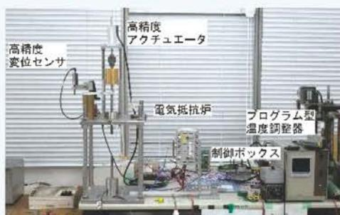
プログラムによる加熱中の変位制御、(分解能：数  $\mu\text{m}$ ) 荷重制御 (分解能：数 N) を行います。(自作装置)
