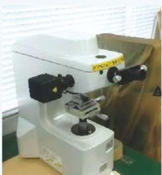
ピッカース、マイクロピッカース硬度を測定できます。接合部の力学特性等を評価します。
