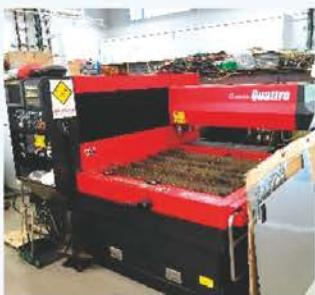
レーザ接合、切断に使用します。2kW発振器（ステージあり）と1kW切断機を所有しています。
